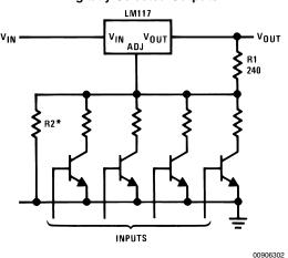
\*Sets maximum  $V_{\text{OUT}}$
