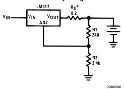
\*R<sub>S</sub>—sets output impedance of charger: Z<sub>OUT</sub> = R<sub>S</sub>  $\left(1 + \frac{R2}{R1}\right)$
